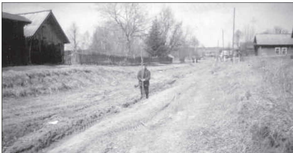
Автор статьи измеряет глубину проседания дороги.
